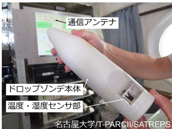
図 1 ドロップゾンデ外観。奥に見えるのがデータ受信システム
