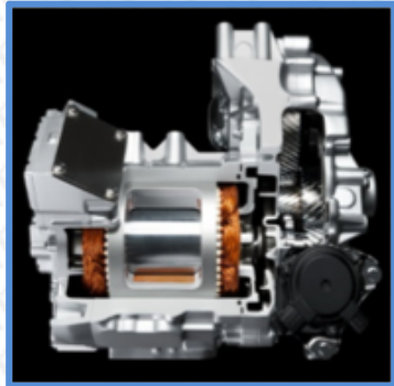
RWD 1モーター 信頼性・加速性能確保
